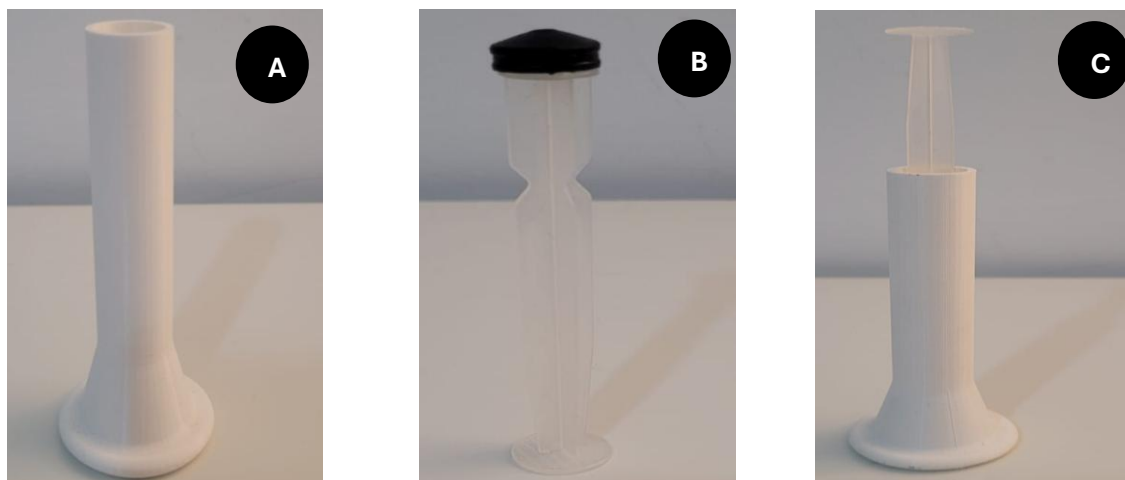
Figura 8 - Impressão em 3D do dispositivo cilíndrico em políácido láctico (PLA). A) Cilindro reto; B) Êmbolo + anel de borracha; C) Dispositivo cilíndrico em posição de uso. Fonte: autor, 2025.
